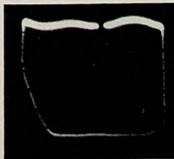
Bild 6. Oszillogramm bei nahezu reellem, angepaßtem Abschluß
