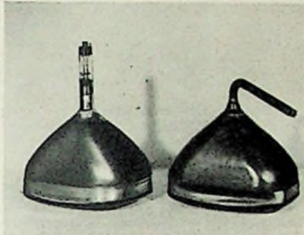
Bild 3. Links eine normale Bildröhre Typ MW 36-22, rechts eine Versuchsröhre mit umgebogenem Hals
