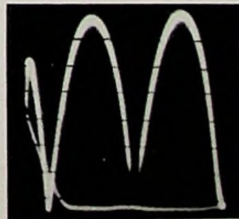
Bild 7. Oszillogramm bei Kurzschluß
